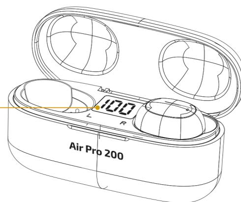
Indicador LED de carga da bateria do estojo de carregamento
