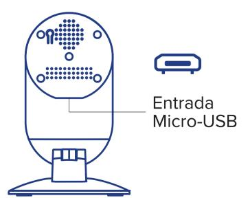
Conecte a ponta do cabo na entrada Micro-USB da Câmera para ligá-la e verifique se o LED na frente está aceso.
